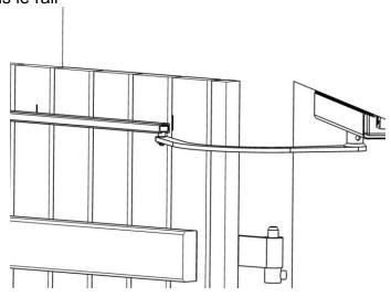
7. 4 Monter les 2 embouts et approcher le volet sur le rail.
