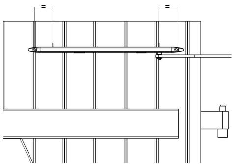
7. 5 aligner le dessous rail sur les 2 repères C à 26 mm du capot, le mettre à niveau puis serrer les vis.
