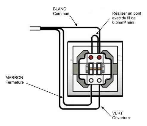
Appuyer sur l'un des boutons et dans un même temps insérer le fil dans l'une des deux cavités situées sous le bouton. Relâcher le bouton, le fil est alors pincé dans la cavité. Vérifier le en tirant légèrement sur ce dernier. Réitérer la manipulation pour chacun des trois fils.
